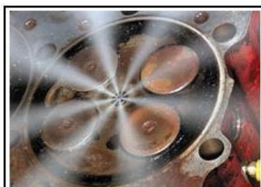
iniezione diretta dopo il trattamento di pulizia
